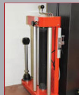
Carrello con tensionamento meccanico Mechanical brake carriage
