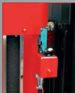
Fotocellula lettura scatola Photoeye to detect box height
