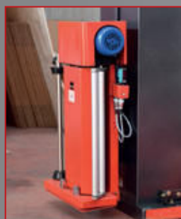
Carrello con prestiro motorizzato fisso Pre-stretch film carriage
