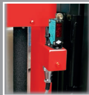
Fotocellula lettura pallet Photoeye to detect pallet height
