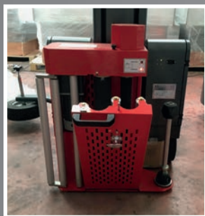
Carrello con prestiro motorizzato fisso Pre-stretch film carriage
