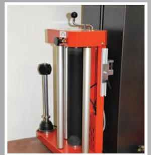
Carrello con tensionamento meccanico Mechanical brake carriage
