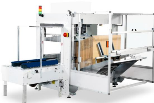
CT 3000 típusú gép CT 302 SD típusú alsó ragasztófejjel
